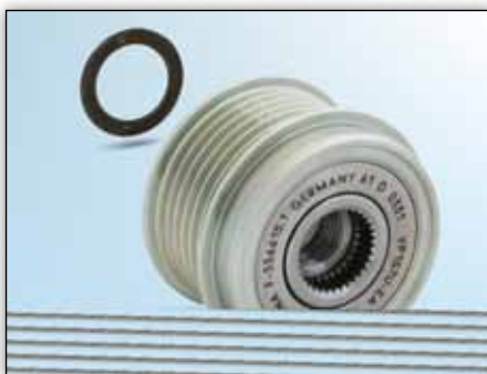
Obrázek 3: Při montáži alternátorové volnoběžky na alternátor Bosch (Ford Transit) je nutno použít přiloženou distanční podložku s tloušťkou 1,4 mm !
