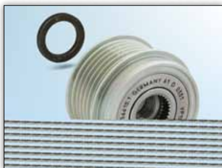
Obrázek 2: Při montáži alternátorové volnoběžky na alternátor Visteon (Ford Mondeo III) je nutno použít přiloženou distanční podložku s tloušťkou 3 mm !
